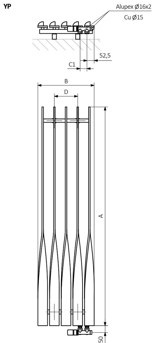
A – hauteur B – largeur C1-C5 – écartement des raccords D – écartement des consoles en horizontal E – écartement des consoles en vertical F – distance de l'axe de la console inférieure au bord inférieur du collecteur
