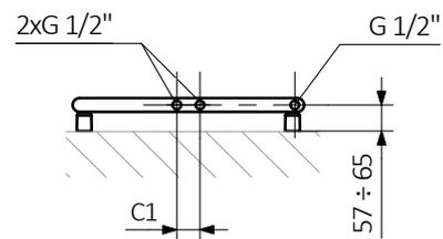
A – hauteur B – largeur C1-C5 – écartement des raccords D – écartement des consoles en horizontal E – écartement des consoles en vertical F – distance de l'axe de la console inférieure au bord inférieur du collecteur
