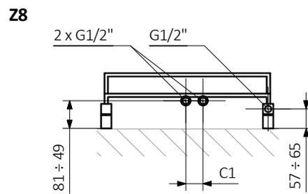
A – hauteur B – largeur C1-C5 – écartement des raccordements D – écartement des consoles en horizontal E – écartement
