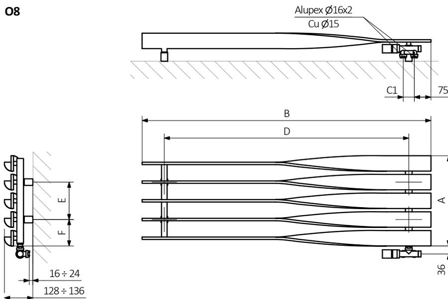
A – hauteur B – largeur C1-C5 – écartement des raccords D – écartement des consoles en horizontal E – écartement des consoles en vertical F – distance de l'axe de la console inférieure au bord inférieur du collecteur
